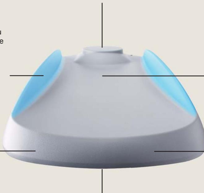
boîtier en aluminium moulé sous pression, revêtu de poudre de plastique (couleur RAL 9022) robuste, résistant aux intempéries et à la corrosion Résistance aux chocs IK10 résistant aux sollicitations mécaniques, par exemple aux fortes grêles
